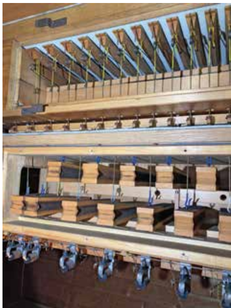
Eine elektro-pneumatische Mechanik wie aus dem Lehrbuch...
