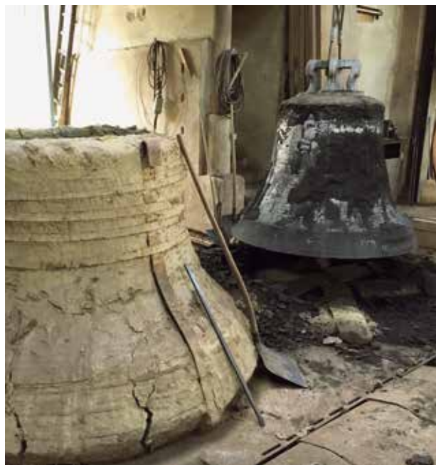
Links der Mantel der Glocke, rechts die Glocke, die im Zwischenraum zwischen Mantel und Kern (vgl. Abb. Seite 9) gegossen wurde.
