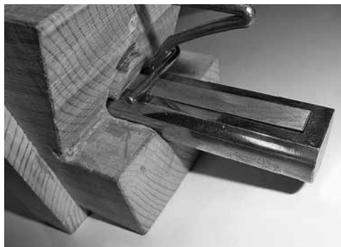
Neu hergestellte durchschlagende Zunge.
