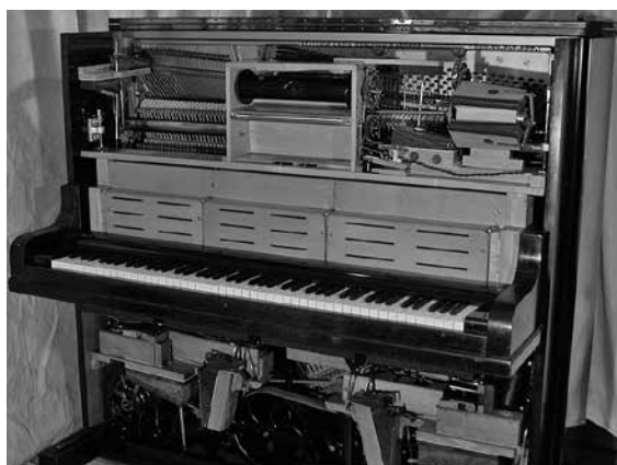
Das geöffnete Steinway- Welte Mignon Reprodukti- onsklavier nach der Restau- rierung.
